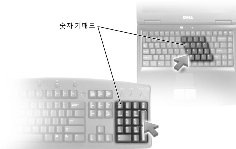
숫자 키패드의 기능은 외부 키보드의 숫자 키패드와 동일합니다. 키패드의 각 키는 여러 기능을 가지고 있습니다. 키패드 숫자 및 기호는 키패드 키의 오른쪽에 청색으로 표시되어 있습니다. 숫자 및 기호를 입력하려면 <Fn> 키를 누른 상태에서 원하는 키를 누릅니다.
